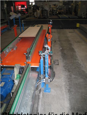
Doppelstapler für die Montage der Spülmaschinen
