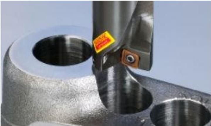
La foratura di superfici irregolari può sottoporre i taglienti della punta a forze eccessive e discontinue, provocandone l'usura precoce.
