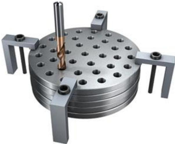
Questo metodo è impiegato per realizzare un numero elevato di fori attraverso lamiere sottili. Tra le applicazioni più diffuse figurano ad esempio la foratura di deflettori per scambiatori di calore e componenti per ponti.
