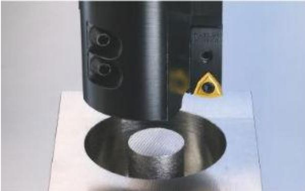
La foratura ad enucleare viene utilizzata per i fori di grande diametro e quando la potenza della macchina è limitata, poiché non richiede lo stesso assorbimento di potenza della foratura dal pieno. L'utensile per la foratura ad enucleare non lavora l'intero diametro ma solo un anello alla periferia. Anziché rimuovere tutto il materiale sotto forma di trucioli, lascia un nucleo (carota) all'interno del foro, pertanto si tratta di un metodo adatto alla lavorazione di fori passanti.
