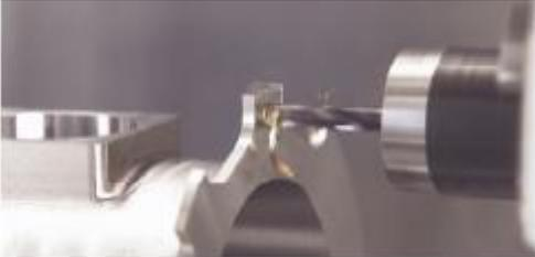
Per la foratura di un componente sottile/debole, la velocità di avanzamento dovrebbe rimanere bassa.
