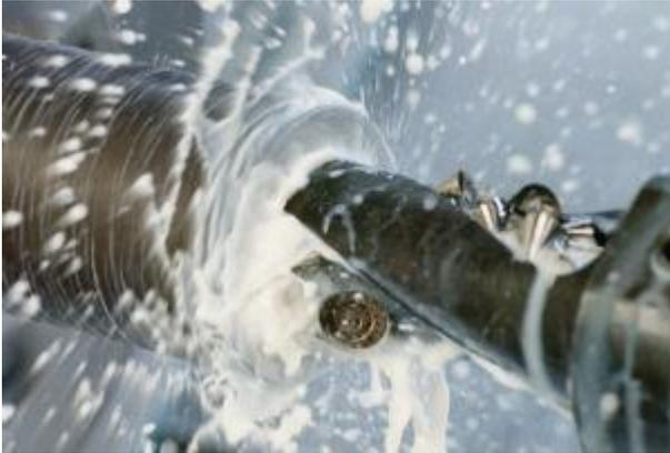
I centri di tornitura e le macchine a fantina mobile con avanzamento barra prevedono spesso la rotazione del pezzo anziché della punta. Quando si usa questo metodo, è estremamente importante verificare che la punta sia allineata all'asse della macchina.
