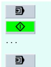
Premere il softkey [Single Block] per passare alla simulazione del blocco singolo. Dopo ogni blocco la simulazione si arresta e prosegue poi con [NC-Start].
