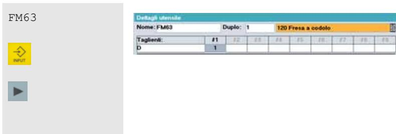
Assegnare un nome al nuovo utensile (ad esempio 'FM63' per una fresa a spianare con  $\varnothing$  63mm).
