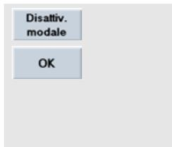
Questi due softkey permettono di disattivare nuovamente la modalità del ciclo e di uscire dal menu di foratura.
