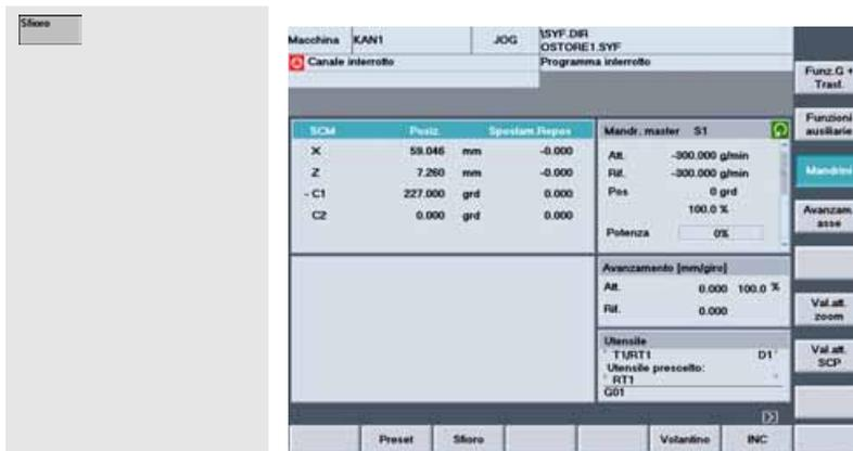
Qui si può attivare la funzione 'Sfioro' mediante un softkey orizzontale.
