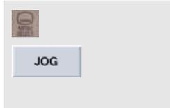
Passare quindi nuovamente al funzionamento manuale (modo operativo 'JOG') (senza premere nel frattempo <Reset> o <Cycle Stop>).
