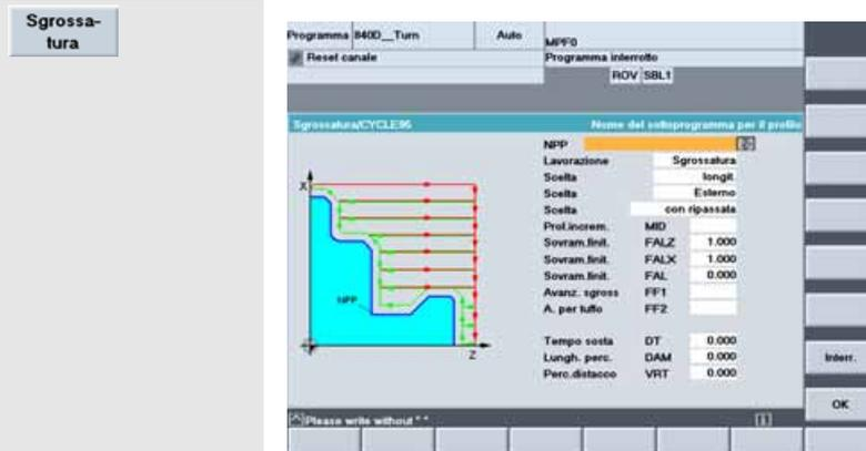
Con il softkey verticale si apre la finestra di dialogo per il ciclo di sgrossatura CYCLE95.
