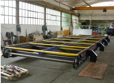
Impianto di trasporto per produzione rete elettrosaldata
